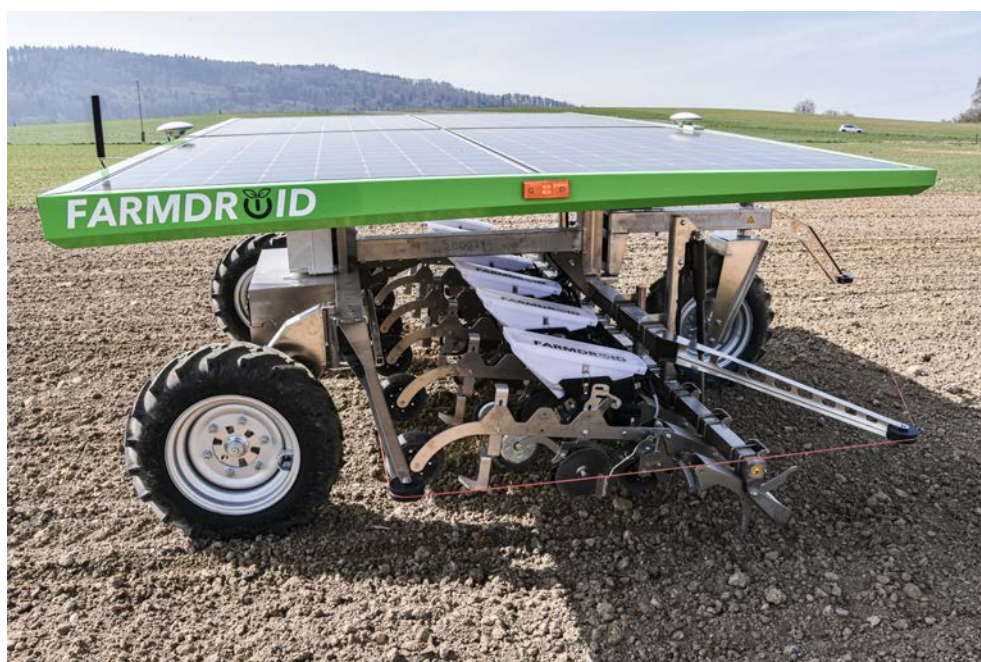
Le robot autonome Farmdroid FD20 sait où se trouve chaque plant de betterave, qu'il contourne pour éliminer les adventices. Droits d'auteur : Hansueli Dierauer, FiBL
