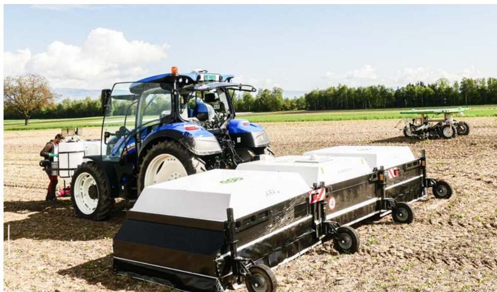
Le robot ARA d'ecoRobotix identifie les adventices et applique les herbicides avec précision. Droits d'auteur : Andreas Keiser, HAFL
