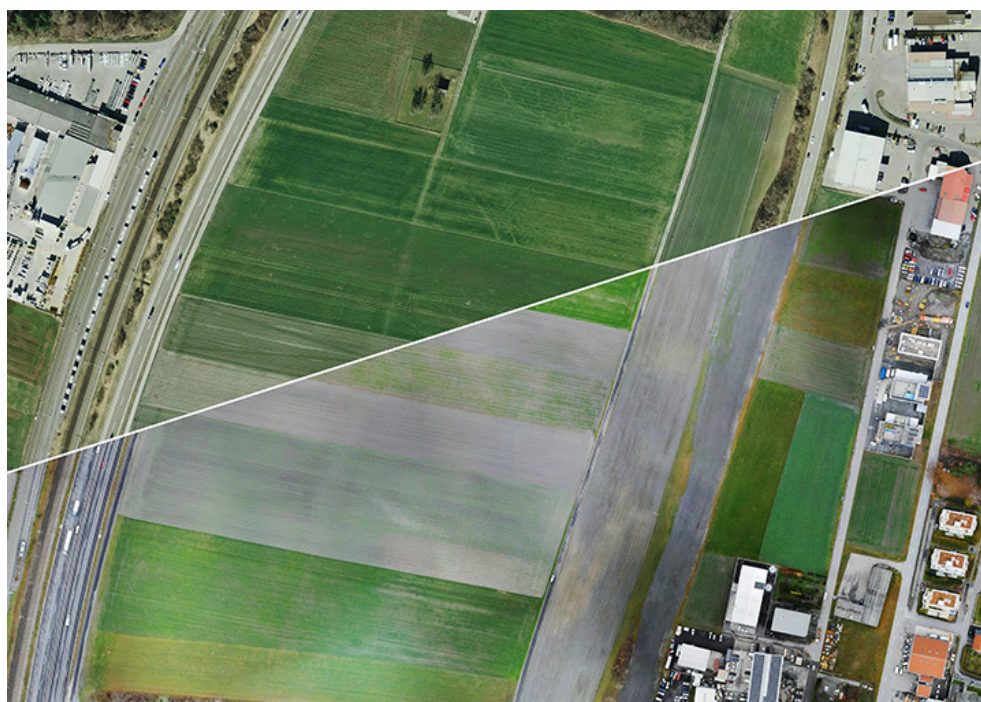
Confronto tra le ortofoto del 2014 (fig. in alto) e del dicembre 2018 (fig. in basso), costruzione della nuova corsia nord (fig. a sinistra) e ripristino della vegetazione sul vecchio tracciato (fig. a destra).
